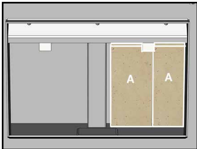
Figure 24: Briques A en place à l'arrière-droite
